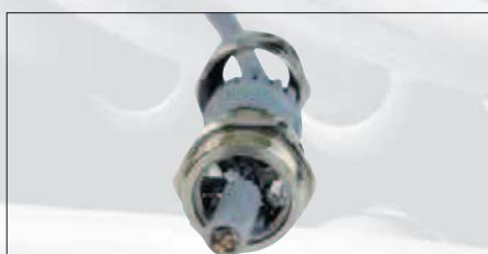
Äusserer Kabelmantel vom umflochtenen Kabel entfernen
