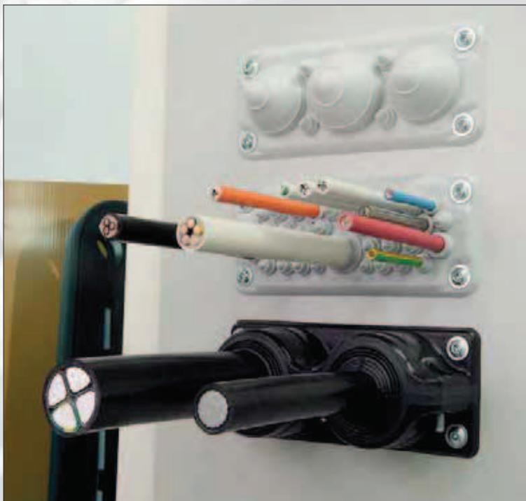
Mit der schwarzen Durchführungsplatine können Sie sogar KSR-Rohre der Grösse M40 – M63 sicher in einen Schaltschrank einführen
