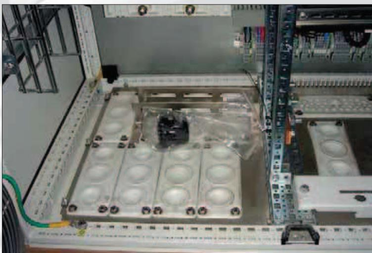
Sämtliche Kabeldurchführungen sind für Innen- und Außenanwendungen im Bereich Schaltschrank-, Anlagen-, Apparate- und Maschinenbau erhältlich
